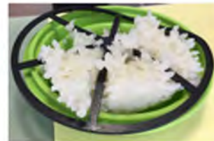
熱と圧力で歪んでしまう⇒材質、厚み
