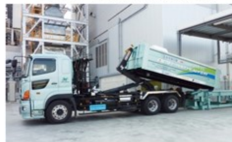
実際に使用されているトランスヒートコンテナ
