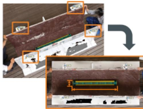
評価方法としてマーカの座標間の実測値、ポリエチレン管長さ・外径の実測値をデータ上の数値と比較を各条件で行い、評価・考察を行った。
