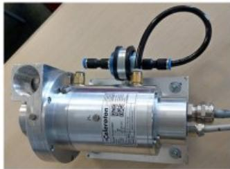
超高速回転空気遠心式圧縮機
