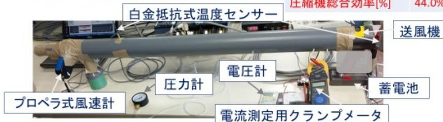
市販の家電の超高速回転送風機を用いて圧縮実験を行い、圧縮機の性能を明らかにした。
