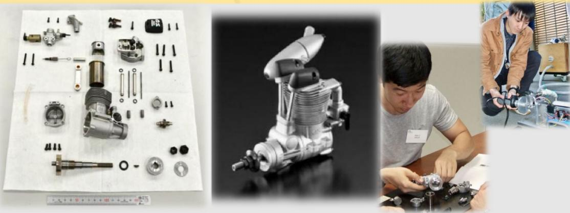
はじめに熱機関に関する簡単な座学やスターリングエンジンの実演を通じて、エンジンの仕組みを学びます。その後模型飛行機用グローエンジンの分解・組立を行い、実際に作動させて熱が動力に変わるエネルギー変換の様子を体験します。(感染予防対策を講じて実施します)
