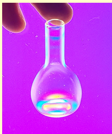
『ひずみ』の可視化 (変色部分が歪み)
